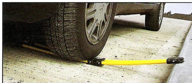
La nouvelle Pince à Déchets de GLASDON a été soumise à des tests rigoureux dans notre Laboratoire Assurance-Qualité. Il a été prouvé que, même après être passée accidentellement sous une voiture (1 tonne), la Pince à Déchets reste intacte et toujours opérationnelle. Même si on essaie de forcer le guide central, celui-ci absorbe les vibrations et assure un bon maintien de l'ensemble.
