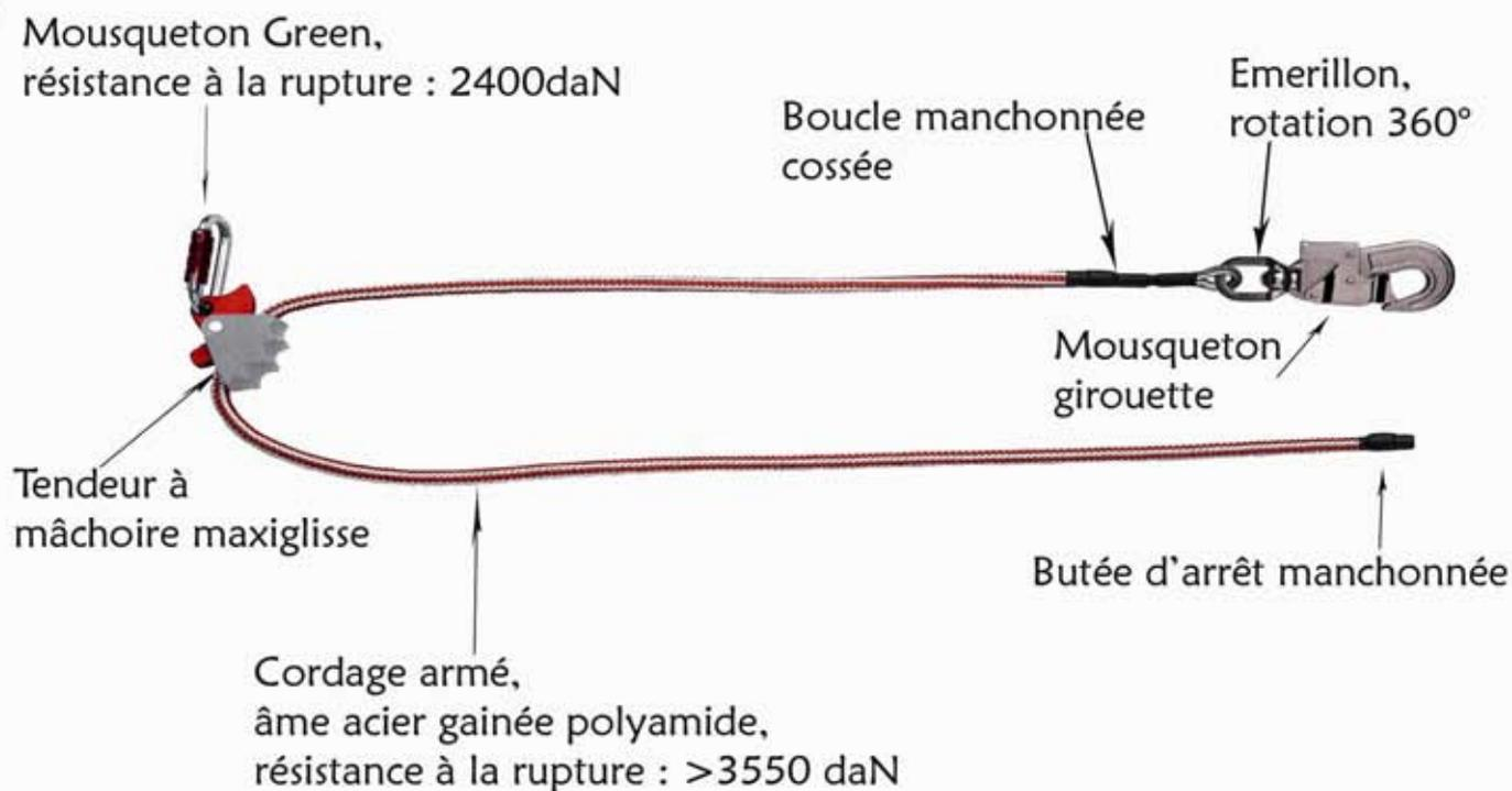
**Produit et utilisation :** Tendeur de longe, réglage très aisé. La forme des doigts dans la poignée assure une parfaite ergonomie. Très léger de part sa fabrication en aluminium. Drisse armée parfaitement adaptée à tous les travaux présentant un risque de coupure accidentel de la longe. Sur ancrages latéraux de harnais ou ceinture conforme EN 358. Le Maxiglisse est un nouveau concept de réglage de tendeur-réducteur de longe. Il allie souplesse de réglage du cordage et blocage efficace.
