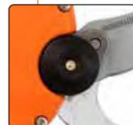
Trou de lubrification et système de verrouillage d'écrou pour un entretien facile
