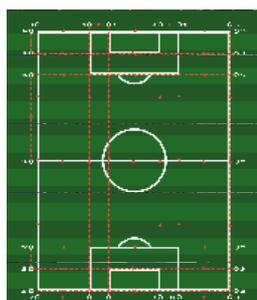
° indiquent la position des implants. Ils sont disposés à 1m à l'extérieur de la zone de jeux, ainsi les LineFix ne sont pas arrachés lors des opérations mécaniques d'entretien sur la zone de jeu.
